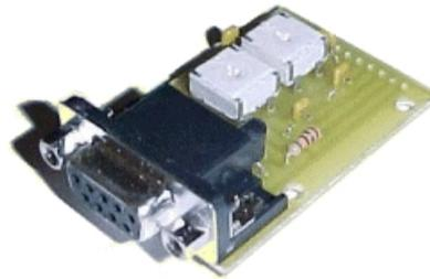
Abbildung 49: Zentrale Komponente eines PTT-Interfaces, preiswerter Bauteil bei „Sander Electronics Components“.
