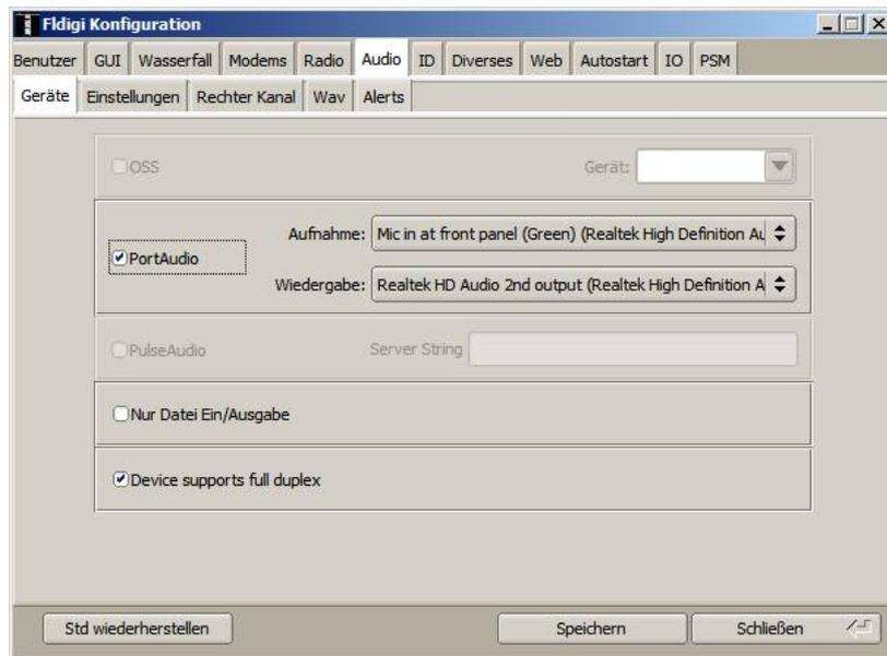
Abbildung 45: Einstellung der Audio-Schnittstelle in fldigi für das Amateurfunk-Fungerät Yaesu FT857, hier werden die im PC eingebauten Audio-Schnittstellen genutzt
