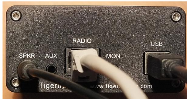
Abbildung 52: Die Steckerbelegung auf der Rückseite des SignaLINK.
