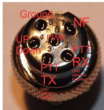
Abbildung 53: Draufsicht: Die Signalbelegung am Mikrofonstecker des AE5890EU, der die Bezeichnung „6-pol-Japanstecker“ (oder „NCS6“ oder „GDCH“) trägt.
