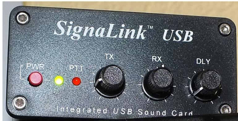
Abbildung 51: SignalINK - sehr gutes PTT-Interface, das insbesondere für CB-Funkgeräte einsetzbar ist, weil diese keine andere Art der Funkgerät-Steuerung zulassen.
