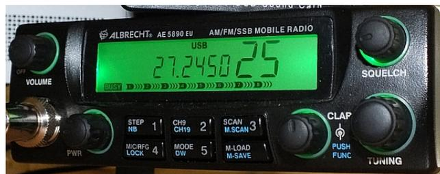
Abbildung 54: Modernes CB-Funkgerät AE5890EU, das viel für Datenfunk im CB-Funkbereich eingesetzt wird, weil es u.a. SSB/12 Watt bietet. Es kann außerdem im 10m- und 12m-Amateurfunkband mit 30W Sendeleistung senden.
